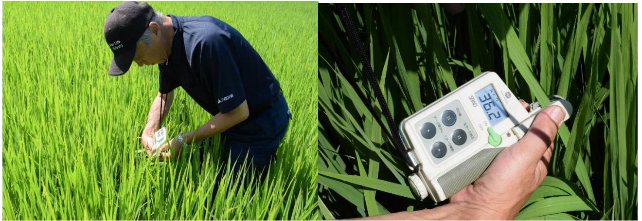
葉緑素計 SPAD による葉色の測定
