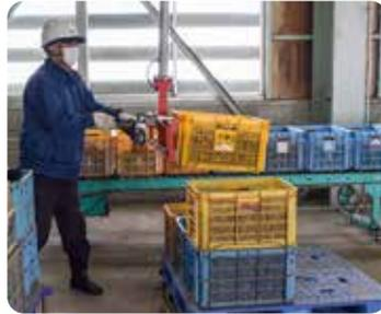
電動リフトでサトイモをコンベアのレーンへ載せます。
