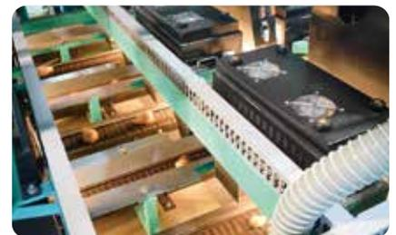
国内トップクラスの性能を誇るカメラ選別コーナー。再び機械によって、色、大きさ、形を一瞬で選別!
